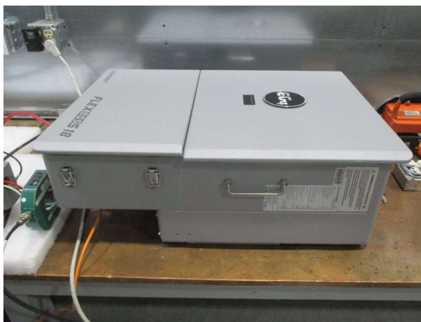
CS115 - EMI02 - EUT Setup
